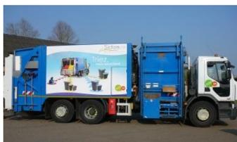
**3 bennes tri-compartmentées** assurent le ramassage quotidien et une benne de secours prend le relais en cas d'indisponibilité d'un des véhicules. Grâce à ces camion-bennes, 3 flux de déchets peuvent être collectés simultanément en limitant les émissions de gaz à effet de serre et en permettant des économies d'énergie.
